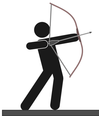
Abb. 15: Beim Bogenschießen wird die Sehne gespannt und dabei der Bogen elastisch verformt. Lässt man die Sehne los, so beschleunigt die Spannkraft des Bogens den Pfeil.
