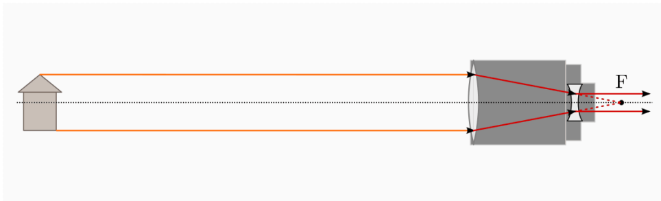
Abb. 140: Strahlengang in einem Galilei-Fernrohr.
