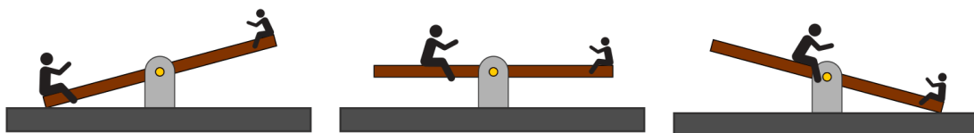
Abb. 35: Die Wippe als (zweiseitiger) Hebel: Nicht nur die wirkende Kraft, auch der Abstand zur Drehachse ist von Bedeutung.
